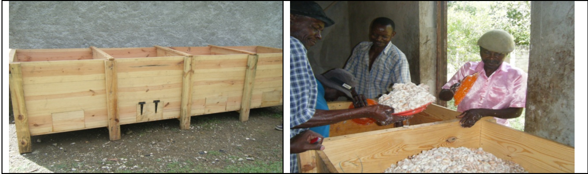
Bacs de fermentation construits avec l'accompagnement du technicien péruvien
