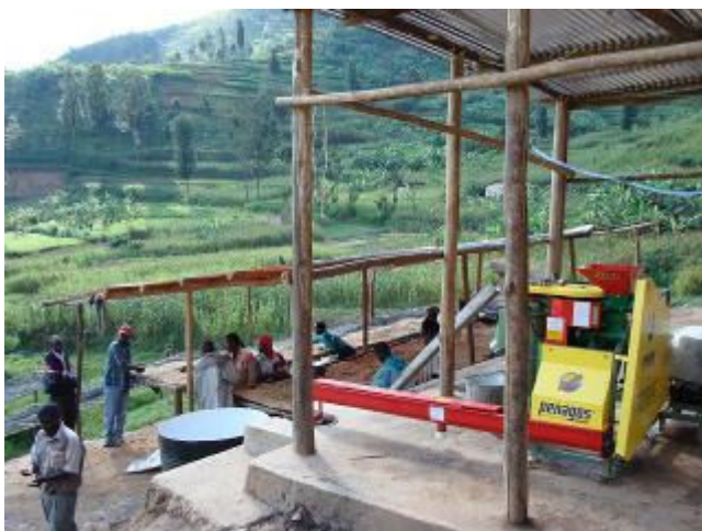
Technologie d'éco-dépulpage installée au Rwanda. Photo de J. Schluter .
